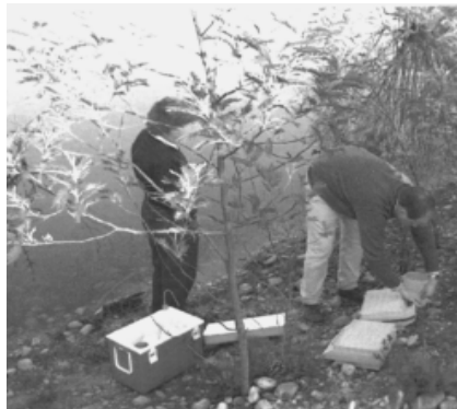
Foto 2 - Barragem do Porco. Determinação de propriedades Físico-Químicas "in-situ" e recolha da amostras.
